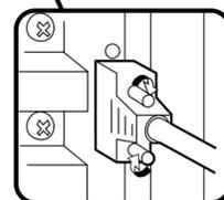
③ ディスプレイの背面につながっているビデオ信号ケーブルのコネクタを、本体のアイコン()とコネクタの形状を確認して、アナログRGBコネクタに、ネジを回して固定する
