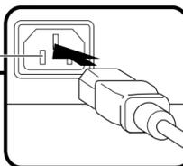
② ディスプレイの電源ケーブルのコネクタを、ディスプレイ背面の電源コネクタに奥までしっかり差し込む
