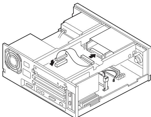
**10** ルーフカバーを、取り外したときと逆の手順で取り付け、ネジで止める
