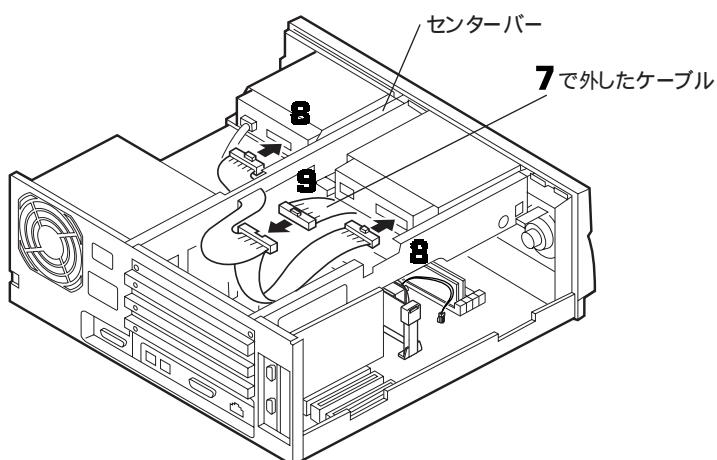
**10** 本体の、増設用3.5インチフロッピーディスクドライブ用電源ケーブルを、下図のように取り付ける
