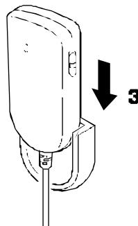
マイクロホンを使わないときは、マイクロホン音声入力スイッチをOFFにして、マイクロホン用ホルダーに取り付けておいてください。
