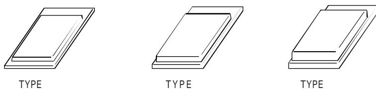
PCカードスロット増設アダプタでは、TYPE IおよびTYPE IIのカードを2枚、またはTYPE IIIのカードを1枚使うことができます。
