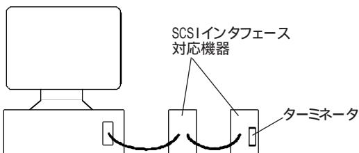
SCSIインターフェース対応機器は、同じ形のコネクタを2つ備えているのが普通です。そして、デイジーチェーンの最後に位置する機器には、ターミネータと呼ばれる終端コネクタを、片方のコネクタに取り付けます。
