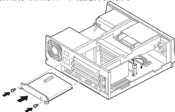
**9** PCカードスロット増設アダプタに添付されているケーブルを、下図のように取り付ける
