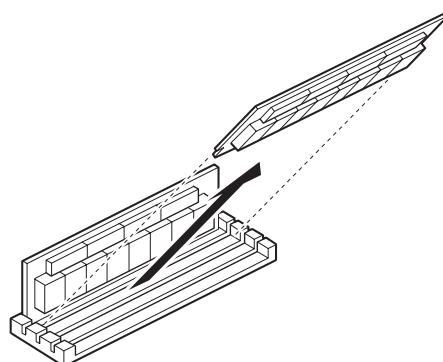
**5** 増設RAMサブボードを、下図のように、増設RAMサブボード用コネクタに斜めに差し込む
