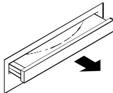
**4** ディスクトレイの前面を、ディスクトレイが元通りに収納されるまで押し込む
