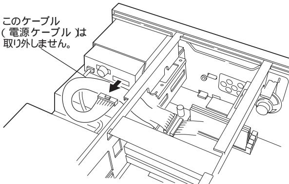
**8** 増設用3.5インチフロッピーディスクドライブに添付されているケーブルの両端のコネクタを、下図のようにフロッピーディスクドライブに取り付ける
