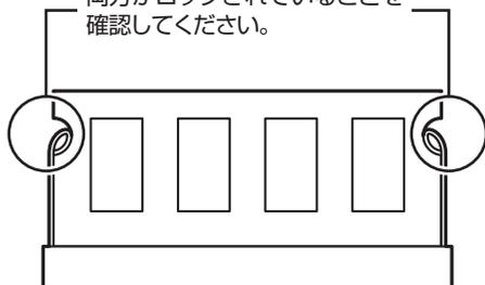
正しくロックされている場合は、メモリが水平で、端子の金色の部分が少し(1mm程度)見える状態です。
