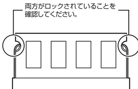
正しくロックされている場合は、メモリが水平で、端子の金色の部分(1mm程度)見える状態です。
