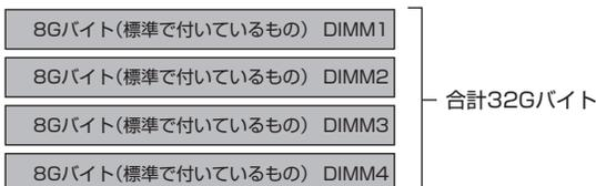
このパソコンはデュアルチャンネルに対応しています。デュアルチャンネルとは、同容量の2枚のメモリに同時にアクセスすることで、メモリのデータ転送性能を高速化する技術のことです。
