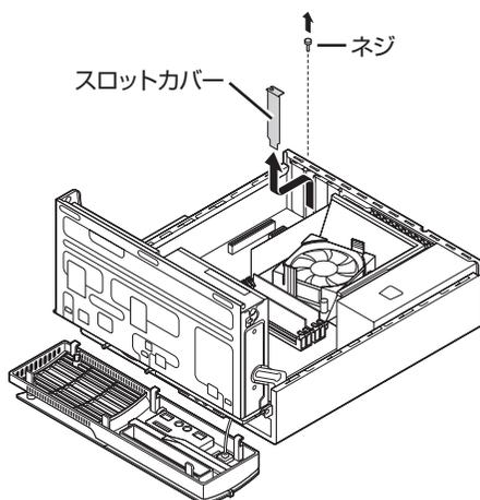
**4** 図のように取り付けるPCI Expressボード/PCIボードの固定部を本体のカード取り付け部に差し込む
