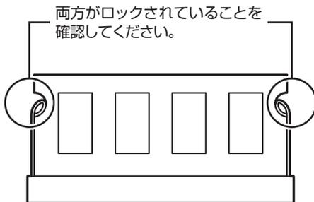
正しくロックされている場合は、メモリが水平で、端子の金色の部分が少し(1mm程度)見える状態です。
