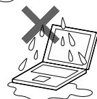
感電の原因になります。万一液体が入った場合は、電源をオフにしてNECサポート窓口(121コンタクトセンター)にお問い合わせください。乾いているようでも本製品内部に水分が残っていることがあります。
