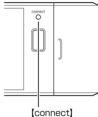
登録が完了するとパソコン本体のCONNECTランプは消灯します。リモコンを操作して正常に動作するか確認してください。
