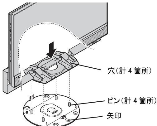
⑤蝶ナット(4個)を取り付け、固く締め付けて、本体とスイベルベースを固定する
