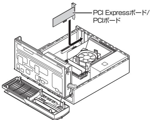
**5** PCI Expressボード/PCIボードをスロットに差し込み、外したネジで固定する
