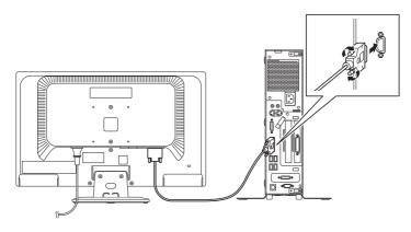
**B-1** 液晶ディスプレイの背面につながっているアナログRGBケーブルのコネクタのアイ コン((○))とコネクタの形状を確認し、本体のアナログRGBコネクタにしっかりネ ジ止めして接続する
