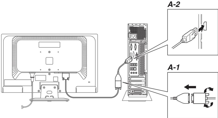
**A-1** 液晶ディスプレイの背面につながっているDVIケーブルのコネクタを、添付のDisplayPort-DVI-D変換アダプタのコネクタにしっかりネジ止めして接続する
