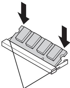
倒し込むときに、この部分が左右に開き、メモリがロックされる位置に戻ります。
