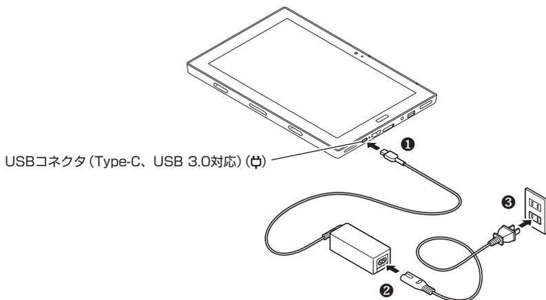
ACアダプタを取り付けると、ACアダプタ接続ランプが点灯します。
