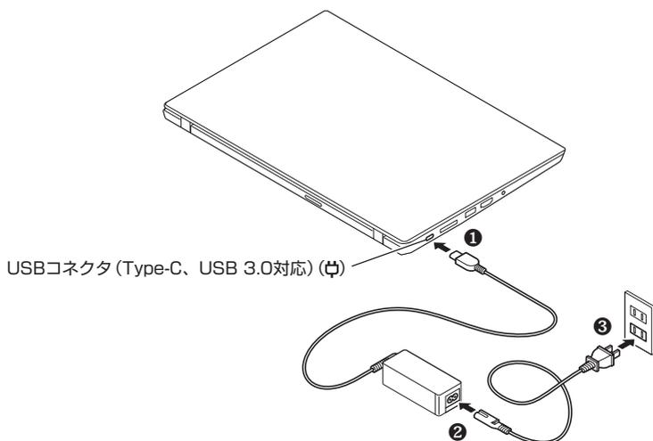
ACアダプタを取り付けると、バッテリーの充電が始まりバッテリー充電ランプが点灯します。バッテリーの充電状態によってはバッテリー充電ランプが点灯しない場合があります。これはバッテリーが95%以上充電されているためです。
