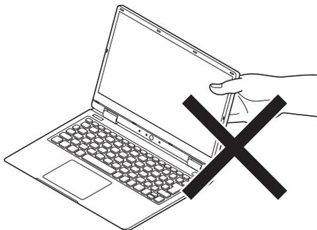
タイプVUをお使いの場合、本体にデタッチャブルキーボードを取り付けて持ち運ぶ際には、必ず下図の点線部を持ってください。点線部以外を持つと、持ち運ぶ際に本体とデタッチャブルキーボードが外れる場合があります。
