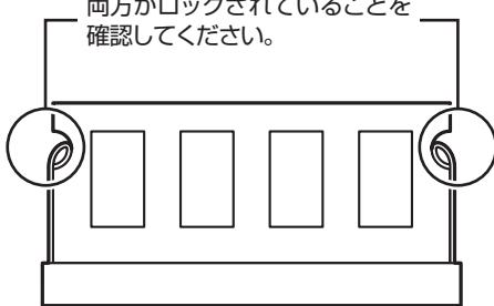
正しくロックされている場合は、メモリが水平で、端子の金色の部分が少し(1mm程度)見える状態です。
