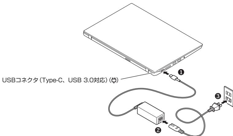
ACアダプタを取り付けると、バッテリの充電が始まりシステムステータスランプが点灯します。バッテリの充電状態によってはシステムステータスランプが点灯しない場合があります。これはバッテリが95%以上充電されているためです。
