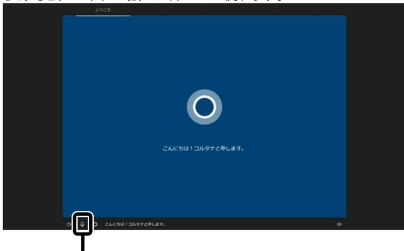
コルタナの機能により、マイクが内蔵されているモデルでは、音声入力で操作することができますが、周囲の音に反応し自動的に設定が適用され、次画面に進んでしまうことがあります。その際には、画面左上の「←」をクリックし、前の画面に戻ってから、再度設定してください。音声ガイダンスや音声入力が必要ない場合は、ここをクリックして音声モードをオフにしてください。
