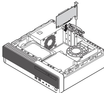
PCI Express×16ボードを取り付ける場合には、ボードが抜け防止ロック機構で固定されていることを確認してください。
