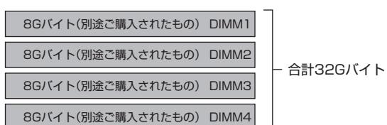
このパソコンはデュアルチャネルに対応しています。デュアルチャネルとは、同容量の2枚のメモリに同時にアクセスすることで、メモリのデータ転送性能を高速化する技術のことです。
