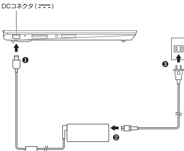
ACアダプタを取り付けると、バッテリの充電が始まりバッテリ充電ランプが点灯します。バッテリの充電状態によってはバッテリ充電ランプが点灯しない場合があります。これはバッテリが95%以上充電されているためです。
