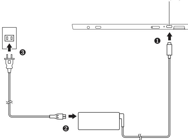
ACアダプタを取り付けると、バッテリの充電が始まりバッテリ充電ランプが点灯します。
