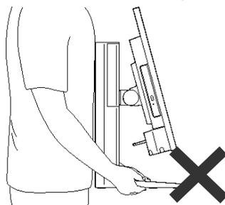
・液晶ディスプレイに衝撃や強い圧力などが加わると、故障や破損の原因となります。移動や設置の際は取扱いに十分ご注意ください。
