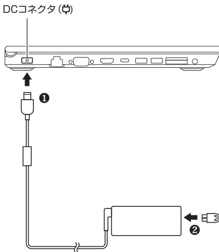
ACアダプタを取り付けると、バッテリの充電が始まりバッテリ充電ランプが点灯します。ただし、バッテリが満充電に近い場合、ランプが点灯しないことがあります。
