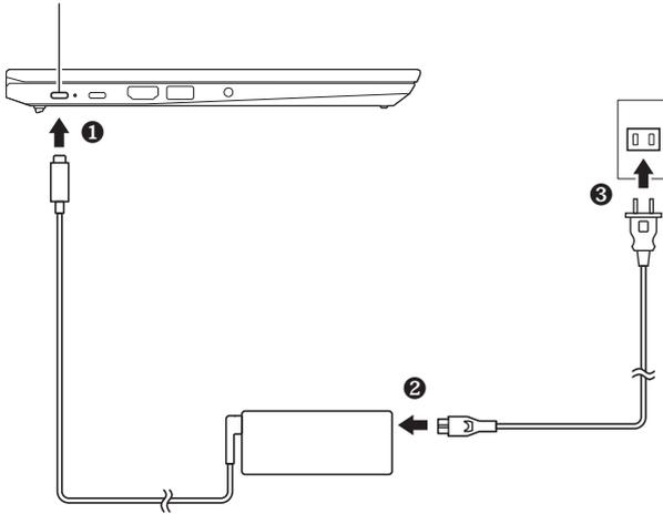
ACアダプタを取り付けると、バッテリーの充電が始まりシステムステータスランプが点灯します。ただし、バッテリーが満充電に近い場合、ランプが点灯しないことがあります。
