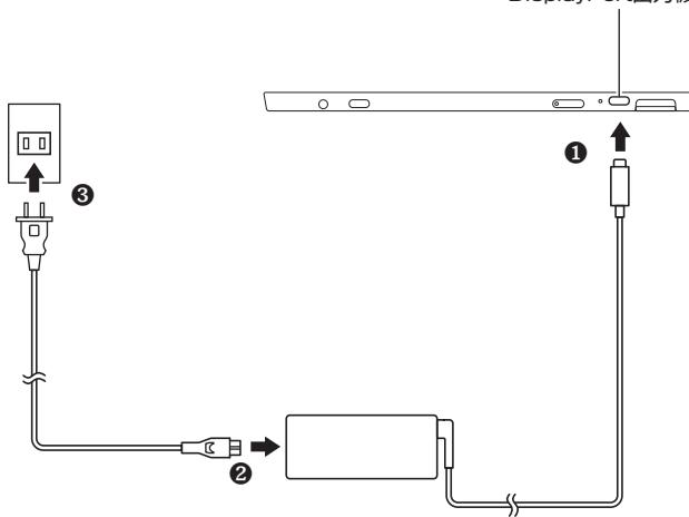
UltraLite タイプVBをお使いの場合、ACアダプタを取り付けると、バッテリの充電が始まりシステムステータスランプが点灯します。タイプVSをお使いの場合、ACアダプタを取り付けると、バッテリの充電が始まりバッテリ充電ランプが点灯します。ただし、バッテリが満充電に近い場合、ランプが点灯しないことがあります。
