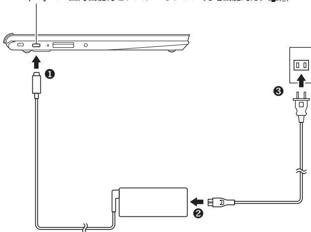
ACアダプタを取り付けると、バッテリの充電が始まりバッテリ充電ランプが点灯します。満充電に近い状態の場合は、ランプが点灯せず、それ以上充電できない場合があります。
