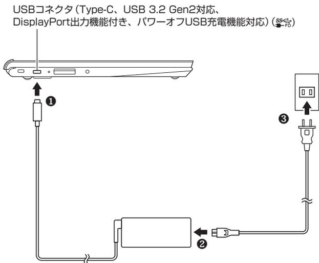
ACアダプタを取り付けると、バッテリーの充電が始まりバッテリー充電ランプが点灯します。満充電に近い状態の場合は、ランプが点灯せず、それ以上充電できない場合があります。
