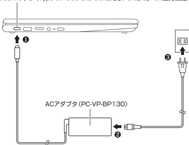
タイプVR以外をお使いの場合、ACアダプタを取り付けると、バッテリーの充電が始まりバッテリー充電ランプが点灯します。ただし、バッテリーが満充電に近い場合、ランプが点灯しないことがあります。タイプVRをお使いの場合は、ACアダプタを取り付けると、バッテリーの充電が始まりACアダプタ接続ランプがオレンジ色に点灯します。ただし、バッテリーが満充電に近い場合、ランプが白色に点灯することがあります。
