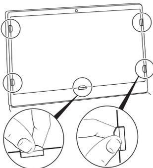
**4** スライドマウントタブとディスプレイの間にプライバシーフィルターを取り付ける
