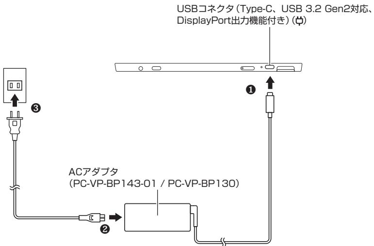
ACアダプタを取り付けると、バッテリの充電が始まりバッテリ充電ランプが点灯します。ただし、バッテリが満充電に近い状態の場合、ランプが点灯しないことがあります。
