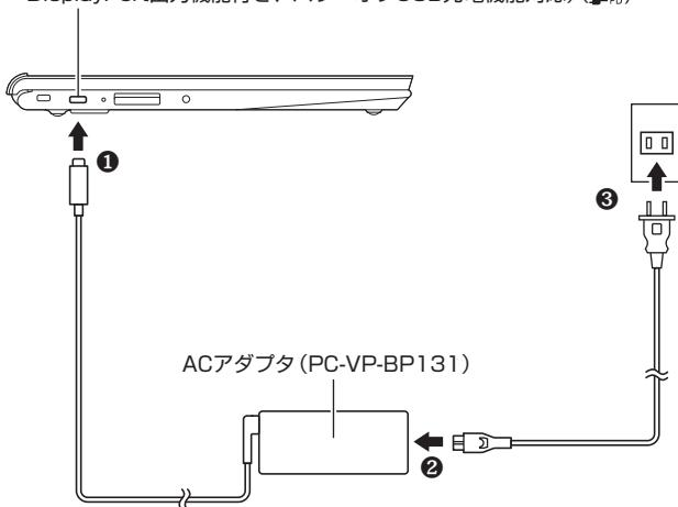
ACアダプタを取り付けると、バッテリーの充電が始まりバッテリー充電ランプが点灯します。ただし、バッテリーが満充電に近い場合、ランプが点灯しないことがあります。
