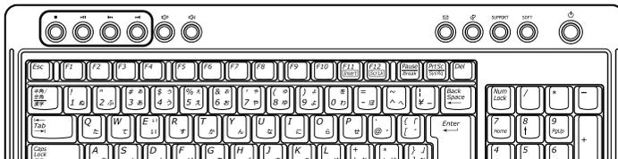
LaVie T では、【頭出し】、【再生/一時停止】、【停止】でも音楽 CD の再生、トラックの変更、巻き戻し、早送り、停止ができます。
