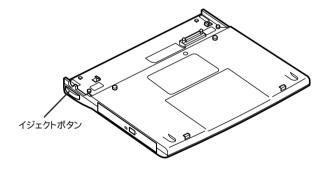
7 ファイルベースの手前側のツメ部に本機底面のくぼみの位置を 合わせ、本機を手前にスライドさせる
