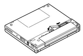
**6** CD-ROMドライブが左側になるようにして、図のようにファイルベースを置くまた、ファイルベースの左右のイジェクトボタンがファイルベースに押し込まれていることを確認する
