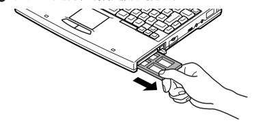
**4** PCカードを、差し込む向きに注意してラベル面を上にして、スロットと水平に静かに差し込む
