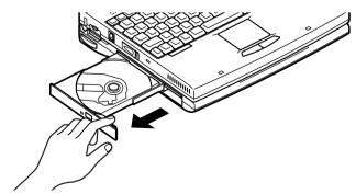
3 文字などが印刷されている面を上にして、CD-ROMをCDトレイ の中心にある軸にはめ込む
