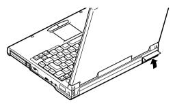
4 本機の右側面のくぼみにポートバーの片方のツメをかけ、本機背面のポートバー用コネクタにポートバーのコネクタを奥までしっかり差し込む
