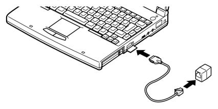
6 添付のモジュラーケーブルの片方を中継アダプタに、もう片方を モジュラープレートなどに接続する
