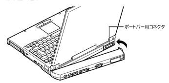
**5** 本機の左側面のくぼみに、ポートバーのもう片方のツメをしっか り押し込む
