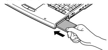
**5** PCカードが完全に差し込まれると、PCカードスロットのイジェクトボタンが少し飛び出すので、イジェクトボタンを手前に引き出してから右に倒す
