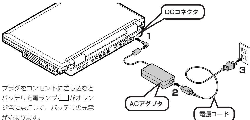
プラグをコンセントに差し込むとバッテリ充電ランプ□がオレンジ色に点灯して、バッテリの充電が始まります。
