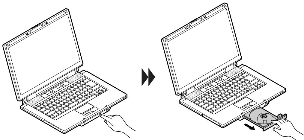
ディスクトレイが少し飛び出したら、手で静かに引き出します。
