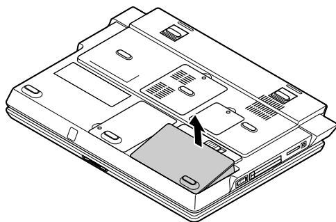
**6** 図のネジをプラスドライバーでゆるめて、メモリスロットのカバーを取り外す
