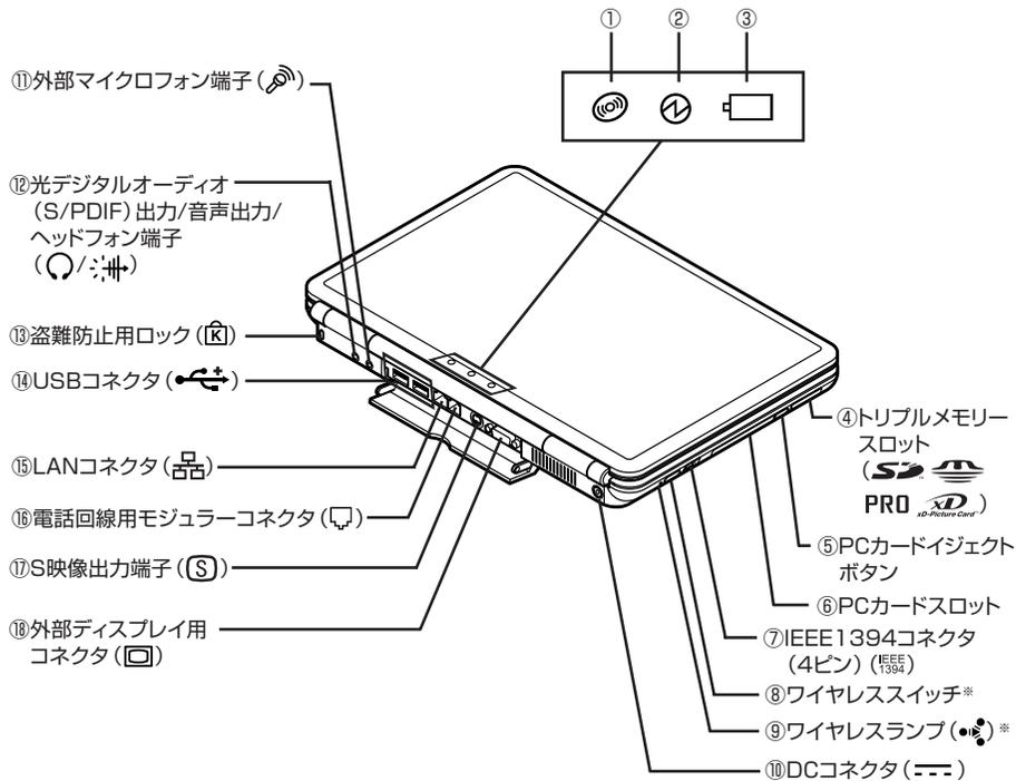
※デュアルモードワイヤレスLANモデル、およびトリプルワイヤレスLAN (Super AG対応) モデルのみ
