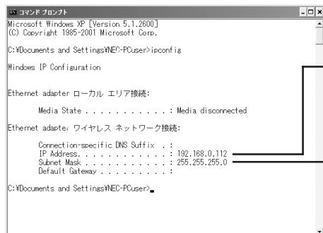
パソコンの無線LANアダプタのIPアドレスは「Ethernet adapter ワイヤレス ネットワーク接続:」の下の「IP Address」の右に表示されます。
