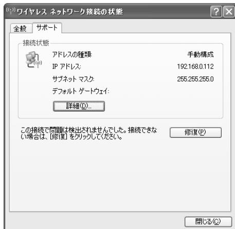
また、「スタート」-「すべてのプログラム」-「アクセサリ」-「コマンドプロンプト」をクリックし、キーボードから「ipconfig」と入力して【Enter】を押して表示される画面でも、パソコンの無線LANアダプタのIPアドレスとサブネットマスクをることができます。
