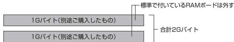
デュアルチャネルとは、同容量/同タイプの2枚のRAMボードに同時にアクセスすることで、メモリのデータ転送性能を約2倍に高速化する技術のことです。
