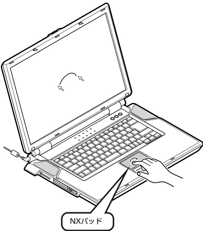
指を動かすと、その動きに合わせて画面の矢印が動きます。指がNXパッドの端で止まって、それ以上動かせなくなったときは、一度指を離してNXパッドの中央に戻して操作すると続けて矢印を動かすことができます。
