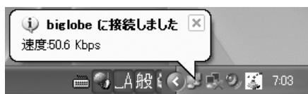
しばらくすると、インターネットに接続され、画面右下に「接続しました」と表示されます。このときに表示されるマーク を、「接続アイコン」と呼びます。このマークが出ているときは、インターネットに接続中で、パソコンが電話回線を使用している（＝電話料金がかかっている）ことを表します。
