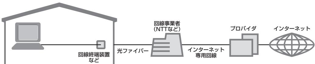
家の中まで光ケーブルを直接引き込み、回線終端装置に接続するという工事をおこなう必要があります。回線終端装置とパソコンは、LANケーブルで接続します。複数のパソコンからインターネットに接続する場合は、回線終端装置とパソコンの間にルータを接続します。
