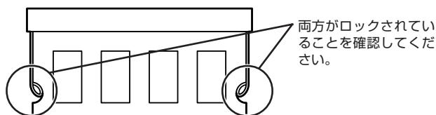
**10 メモリスロットのカバーをもとに戻し、ネジでカバーを本体底面に取り付ける****11 バッテリパックと AC アダプタを取り付ける**
