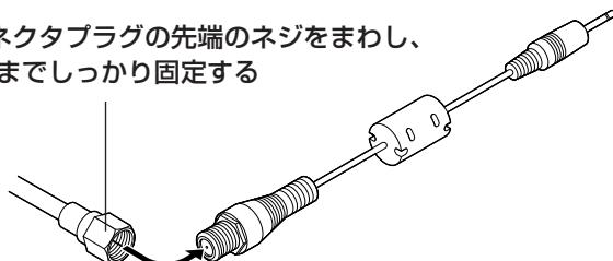
! コネクタ中心部の小さな穴に、F型コネクタプラグの中心にある金属線を差し込んでください。金属線は折れやすいので、ていねいに扱ってください。
