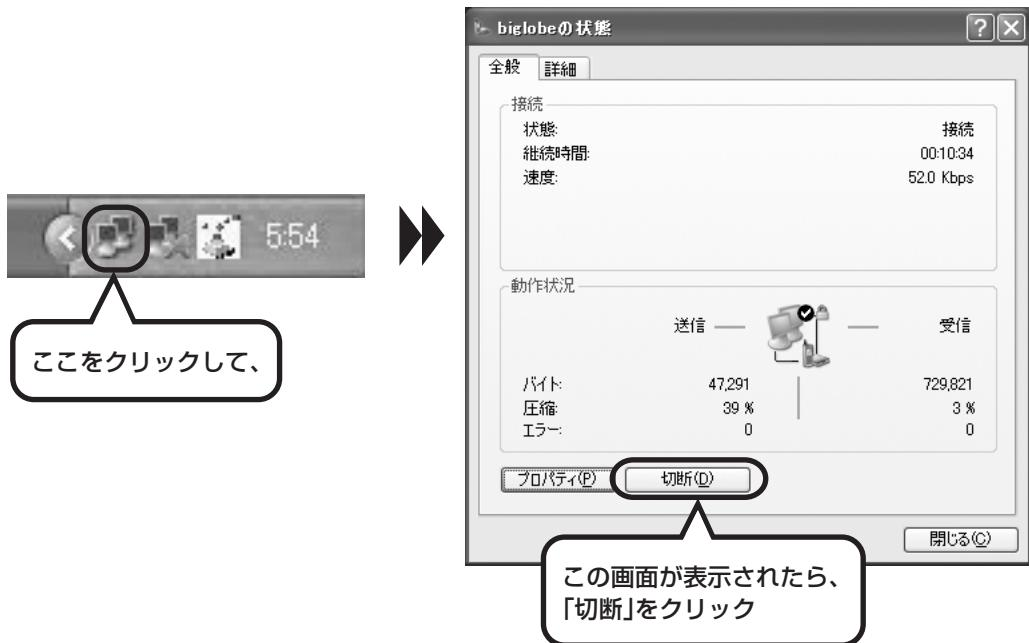
インターネットへの接続が切れると、
