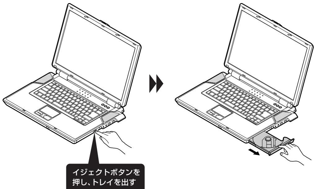
ディスクトレイが少し飛び出したら、手で静かに引き出します。
