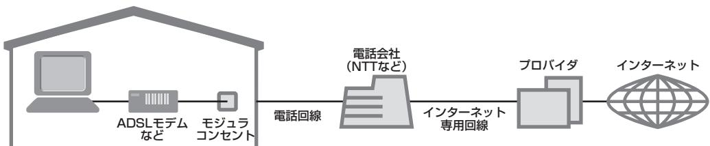
ADSL モデムには、おもに「ブリッジタイプ」と「ルータタイプ」の2種類があります。ブリッジタイプのADSL モデムは、1台のパソコンからインターネットに接続できます。ルータタイプのADSL モデムは、複数のパソコンからインターネットに接続できます。
