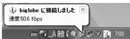
しばらくすると、インターネットに接続され、画面右下に「接続しました」と表示されます。このときに表示されるマーク
