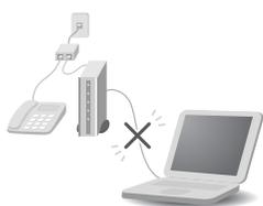
ブロードバンドを利用するときは、パソコンとネットワーク機器をLANケーブルで接続します。ワイヤレスLANを使うと、この部分のケーブル接続が不要になります。
