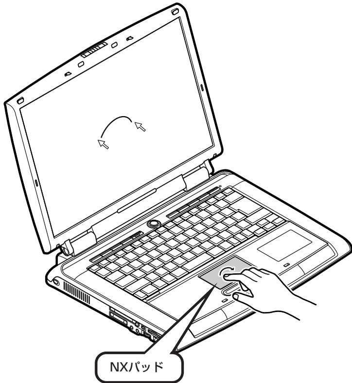
指を動かすと、その動きに合わせて画面の矢印が動きます。指がNXパッドの端で止まって、それ以上動かせなくなったときは、一度指を離してNXパッドの中央に戻して操作すると続けて矢印を動かすことができます。
