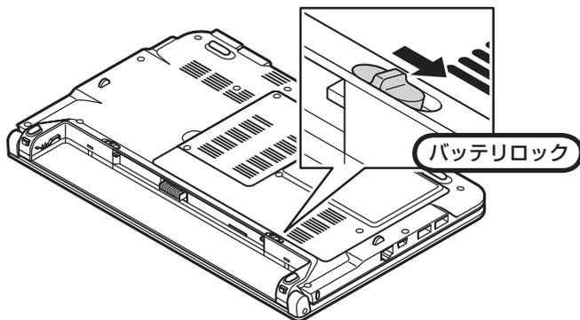
**2** バッテリーパックの両側のミゾと本体のガイドを合わせて、バッテリーパックを矢印の方向にスライドさせ、カチッと音がするまでしっかり取り付ける
