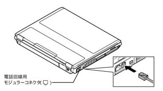
▲ モジュラーケーブルのもう一方のプラグを、壁面などのモジュラーコンセン トに接続する
