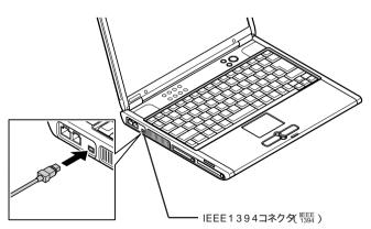
? IEEE1394ケーブルのもう一方のプラグを、取り付ける機器のIEEE1394 コネクタに接続する
