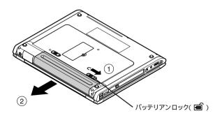
6 新しいバッテリパックの底面のガイドと本体の溝を合わせて、図の矢印の方 向にスライドさせ、カチッと音がするまでしっかり取り付ける 取り付けるときは、バッテリパックの向きに注意してください。
