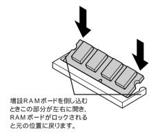
♀ 増設RAMボードがコネクタにしっかりロックされたことを確認する 正しくロックされている場合は、増設RAMボードが水平で、端子の金色の部分が 少し(1mm程度)見える状態です。
