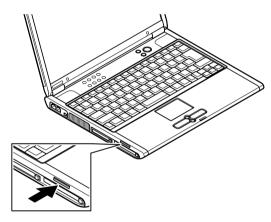
2 「SDメモリーカード」「メモリースティック」「メモリースティックPRO」を 水平に引き抜く
