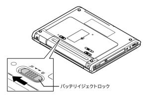
5 バッテリアンロック(回)を図の矢印の方向にスライドさせたまま、バッテリ パックを外側にスライドさせて取り外す
