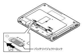
3 バッテリパックの底面のガイドと本体の溝を合わせて、矢印の方向にスライ ドさせ、カチッと音がするまでしっかり取り付ける 取り付けるときは、バッテリパックの向きに注意してください。
