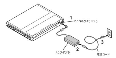
プラグをACコンセントに差し込むとバッテリ充電ランプ( がオレンジ色に点 灯して、バッテリの充電がはじまります。
