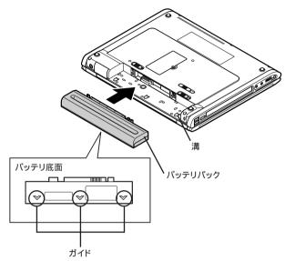
▲ バッテリイジェクトロックを図の矢印の方向にスライドさせ、バッテリパッ クをロックする
