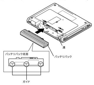
7 バッテリイジェクトロックを図の矢印の方向にスライドさせ、バッテリパッ クをロックする
