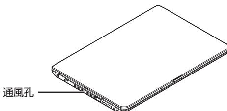
**通風孔**は、パソコン内部の熱によってパソコンが故障したり誤作動したりすることを防ぐための換気口です。ほこりがたまってしまうと機能が低下し、パソコンの故障や誤作動などのトラブルの原因になる場合があります。定期的にお手入れをしてください。
