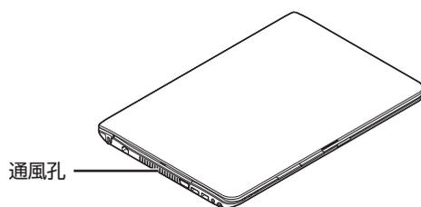
通風孔は、パソコン内部の熱によってパソコンが故障したり誤作動したりすることを防ぐための換気口です。ほこりがたまってしまうと機能が低下し、パソコンの故障や誤作動などのトラブルの原因になります。定期的にお手入れをしてください。
