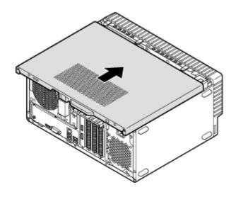
3. 「サイドカバーの外し方」で取り外したネジでサイドカバーを固定する
