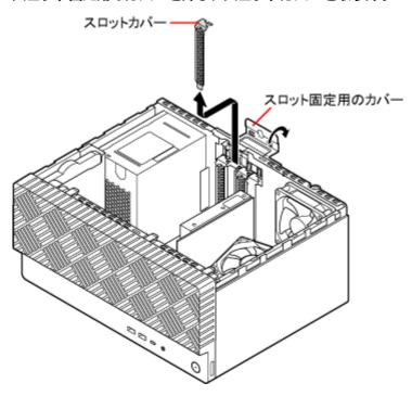
3. PCI Expressボードをスロットに差し込み、スロット固定用のカバーを元に戻す
