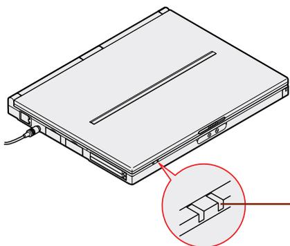
AC アダプタを取り付けると、自動的にバッテリーの充電がはじまり、バッテリー充電ランプ(
