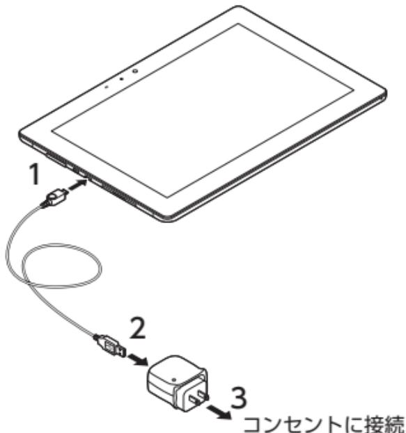
プラグをコンセントに差し込んだら、液晶ディスプレイが点灯することを確認してください。
