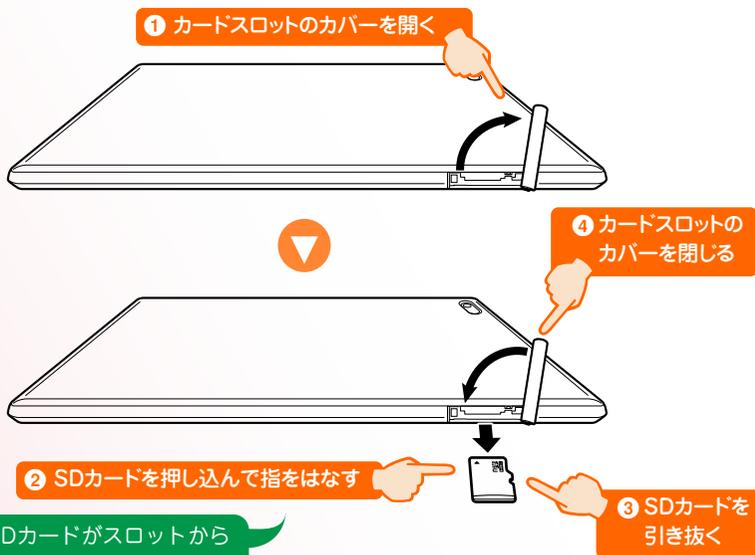
SDカードがスロットから少し飛び出します。
