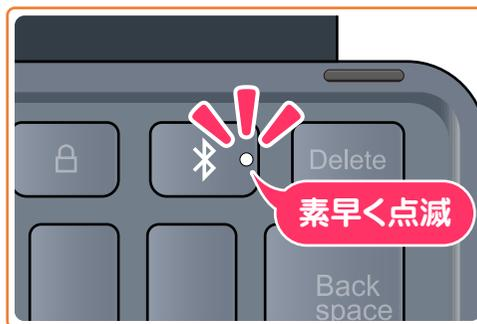
ペアリング設定中、またはタブレットをキーボードから取り外したときはランプが素早く点滅します。ペアリングが完了すると、点滅が止まります。
