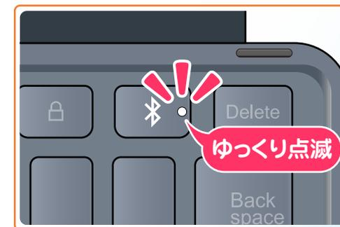
キーボードコネクタにタブレットを接続しない状態で、Bluetoothボタンを長押し（5秒以上）すると、ペアリング先の検索中となり、ランプがゆっくり点滅します。3分以内にペアリングが完了すると、点滅が止まります。ペアリングが完了しない場合は、しばらく点滅し続けますが、3分後に点滅が止まります。
