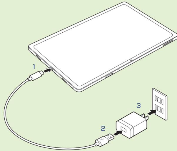
プラグをコンセントに差し込んだら、液晶ディスプレイが点灯することを確認してください。
