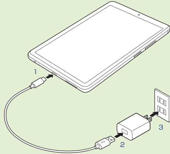
プラグをコンセントに差し込んだら、液晶ディスプレイが点灯することを確認してください。
