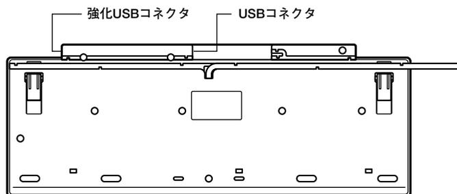
片方のコネクタには添付のUSBマウスを接続します。もう片方のコネクタには別売のUSB機器を接続して利用することができます。指紋センサ機能付きUSB小型キーボードの左側面のUSBコネクタは、頻繁に抜き差しをする機器の接続に使用するために、通常のUSBコネクタよりも抜き差しに強くなっています。添付されているUSBメモリなどを使用する場合は、強化USBコネクタを利用することをおすすめします。
